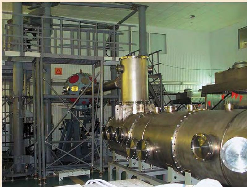
Вакуумный компрессор и мишенная камера установки «Луч»
