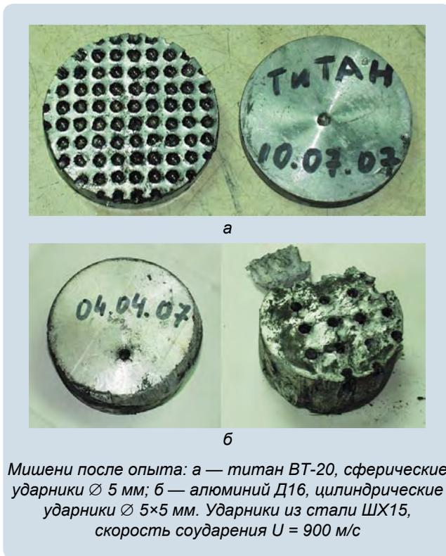
Мишени после опыта: а — титан ВТ-20, сферические ударники  $\varnothing 5$  мм; б — алюминий Д16, цилиндрические ударники  $\varnothing 5 \times 5$  мм. Ударники из стали ШХ15, скорость соударения  $U = 900$  м/с
