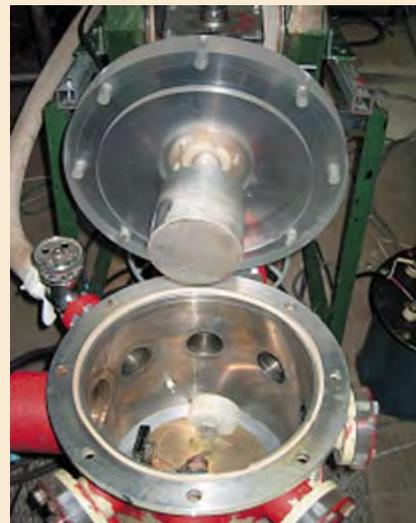
Камера для напыления и имплантации
