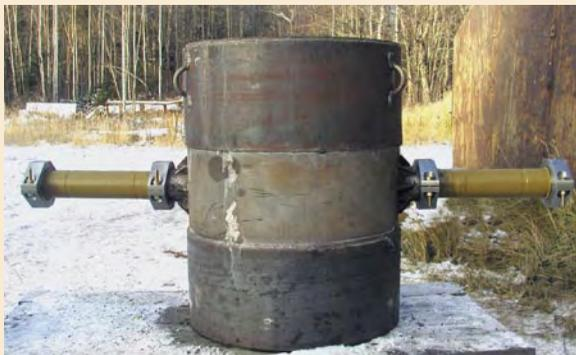
Камера после испытания взрывом мощностью 1,35 кг ТЭ
