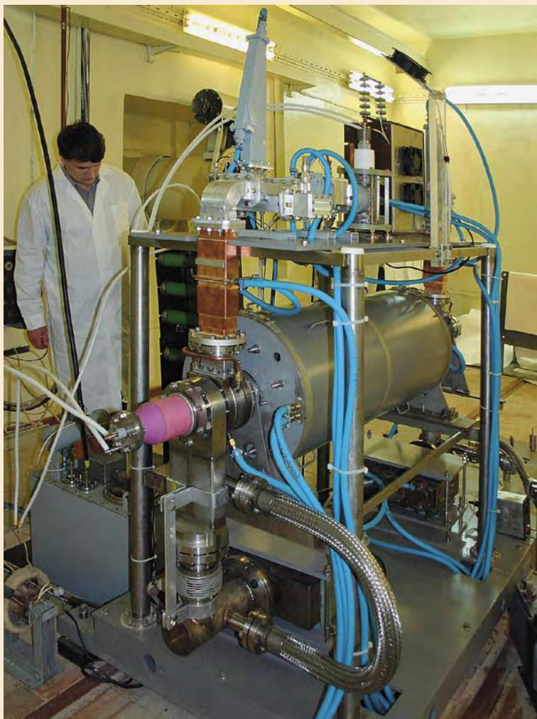
Излучающий модуль ускорителя, собранного на транспортировочной платформе
