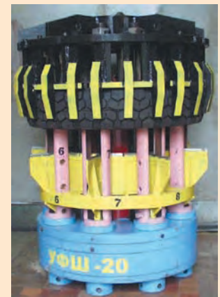
Установка для резки изношенных автомобильных шин
