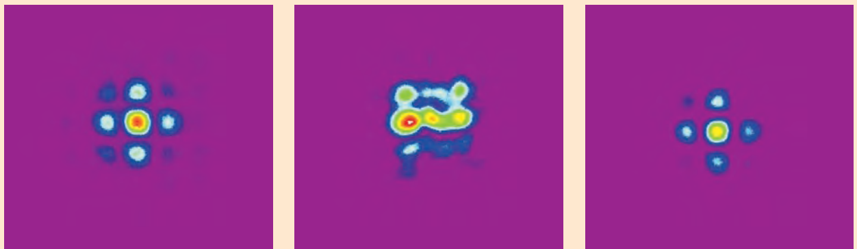
Распределение в дальней зоне излучений опорного пучка (а), опорного излучения, дважды прошедшего через усилитель (б), и усиленного стоксова излучения (в)
