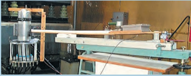
Испытание образца механическим импульсом от электрического взрыва фольги с бесконтактным измерением динамики образца
