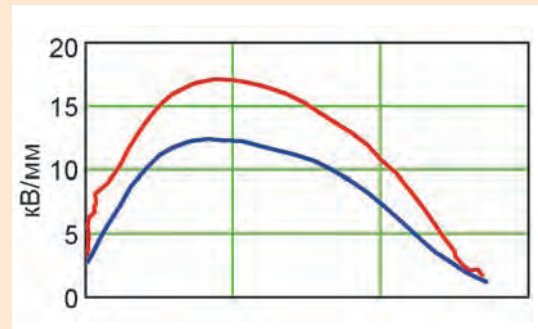
Распределение напряженности электрического поля вдоль поверхности раздела в вакууме и полиэтилене при напряжении на сборке 400 кВ
