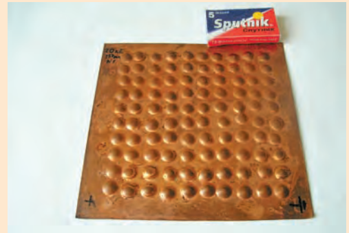
Индикаторная пластинка после газодинамического воздействия электрического взрыва алюминиевой фольги толщиной 6 мкм
