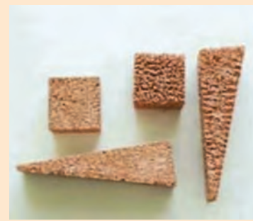
Пресс-материал из медной проволоки (а) и мишени на его основе (б)
