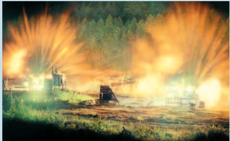
Интегральная картина свечения источника энергии на основе двух генераторов ВМГ-160, полученная с помощью фотокамеры с открытым затвором
