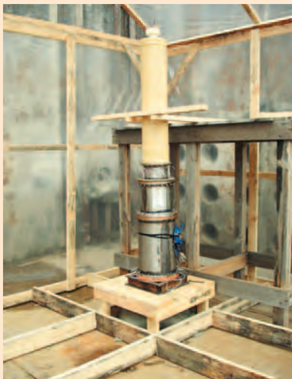
Пятиэлементный ДВМГ-240 со взрывным размыкателем тока на исходной позиции
