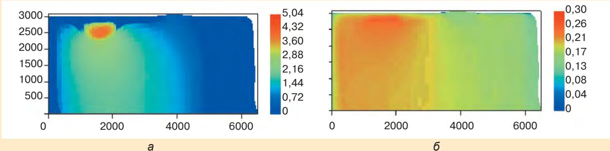
Пространственное распределение температуры электронов (а) и излучения (б) на момент середины лазерного импульса в расчете для второй гармоники
