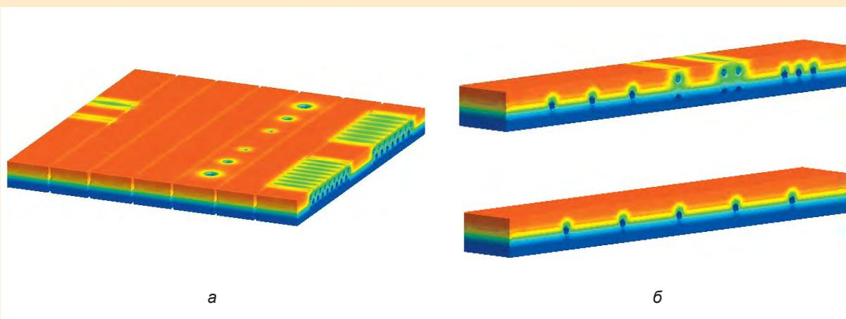
Численное моделирование экспериментов по компактированию цилиндрических каналов в уране. Распределение давления в образцах на момент времени 1,5 мкс: а – во всех исследуемых в эксперименте образцах; б – в образцах с одиночными каналами
