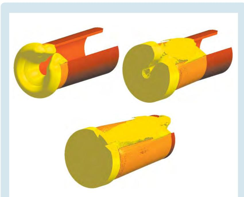
Численное моделирование экспериментов по исследованию предельной деформации разрушения разлетающихся урановых оболочек. Разлет уранового цилиндра
