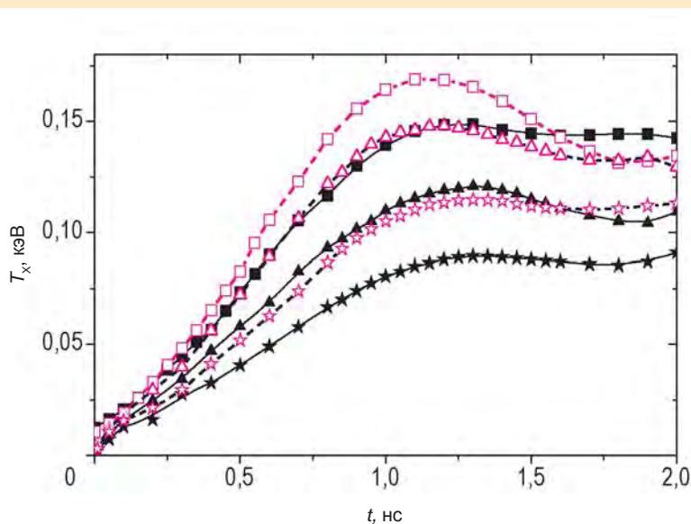
Зависимость эффективной температуры рентгеновского излучения от времени при  $f = 0,1$  (светлые маркеры) и  $f = 0,03$  (темные маркеры) для сферического бокса с покрытием из золота, меди или магнезия, внутри которого расположена капсула с термоядерным топливом:
