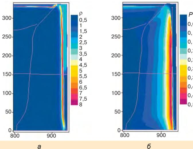
Пространственное распределение плотности (а) и давления (б) на момент выхода ударной волны из базового слоя алюминия толщиной 20 мкм
