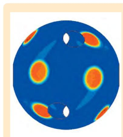
Схема лазерной освещенности внутренней поверхности сферического бокса в экспериментах на второй гармонике иодного лазера  $\lambda = 0,657$  мкм (резко выделяются зоны пятен первичной лазерной засветки)
