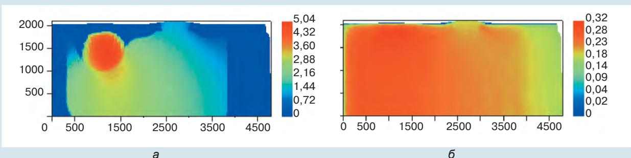
Пространственное распределение температуры электронов (а) и излучения (б) на момент середины лазерного импульса в расчете для третьей гармоники
