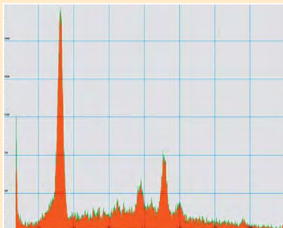
Аппаратный спектр излучения насыщенного тритием стального образца, покрытого слоем золота
