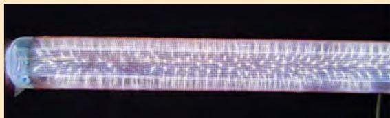
Цилиндрическая эксилламп барьерного разряда
