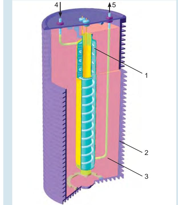
Фотопректор барьерного разряда для обработки жидкостей и газов: 1 – канал циркуляции обрабатываемой жидкости (газа); 2 – корпус радиатора; 3 – масляная ванна; 4 – ввод обрабатываемой среды; 5 – вывод обрабатываемой среды
