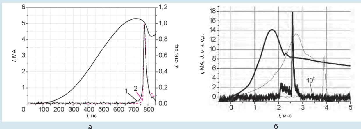
Импульсы тока и МРИ для ВМГ-200 (а) и ДВМГ240 (б): 1 – эксперимент; 2 – расчет с «навязанным» током
