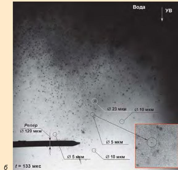
Видеокадры процесса диспергирования жидкости: а – выбрасываются тонкие струи; б – струи распадаются на капли
